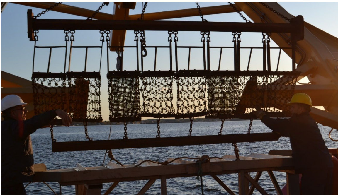
Figure 6. Engin d'un relevé de recherche composé d'une drague à pétoncle de type Digby à huit paniers (anneaux de 82,6 mm) dont deux sont revêtus (mailles de 18 mm) utilisé dans les relevés des pétoncles en 2019 et 2023 dans le sud du Golfe du Saint-Laurent.
