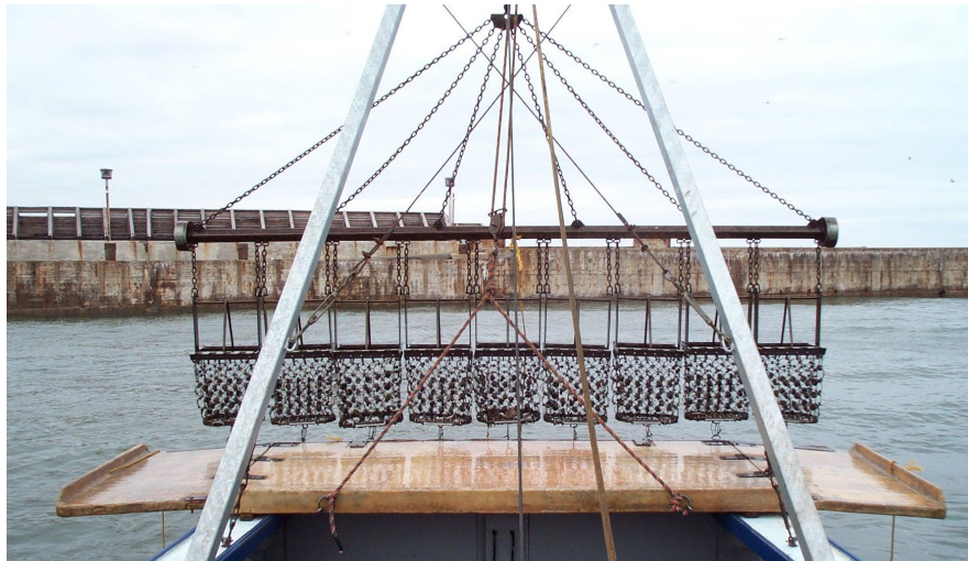
Figure 2. Drague de type Digby à neuf paniers couramment utilisée dans la pêche du pétoncle géant dans la région du Golfe.
